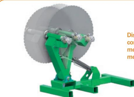
Disco in widia diametro 900 o 1200 mm con trasmissione idraulica, montato su robusto braccio di taglio, movimentato da cilindro idraulico elettro assistito
